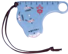
07 マップメーター -75053 ¥540 地図上の 1cm は 1/25,000 と 1/50,000 の地図ではそれぞれ何 km になるか一目で分かる。スカウト必携の入門用マップメーター。ルーベ、分度器 (目盛を直線にした所がミン) 付。
